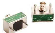
**Shear Wave** (příčná vlna) - velká jednoměničová sonda pro použití s úhlovým klínem pro účinnou detekci defektů
